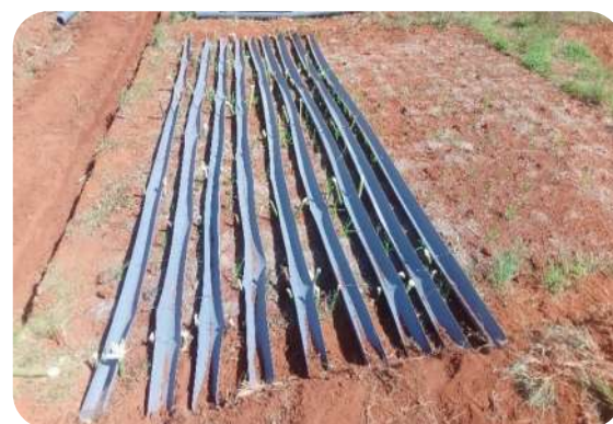
Figure 4 : Dispositif de réduction de pluies. A gauche, une parcelle élémentaire
